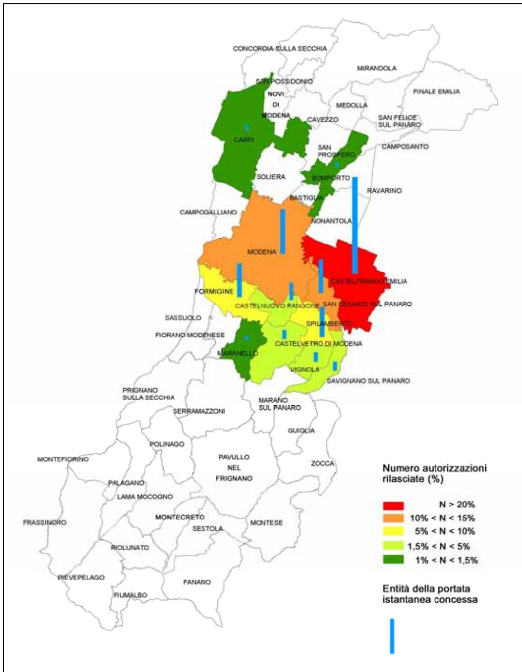
Figura 5.4.1.3.b - Distribuzione del numero di autorizzazioni e delle portate istantanee (l/s) cumulative per comune, relative alle concessioni di derivazione da acqua superficiale.
